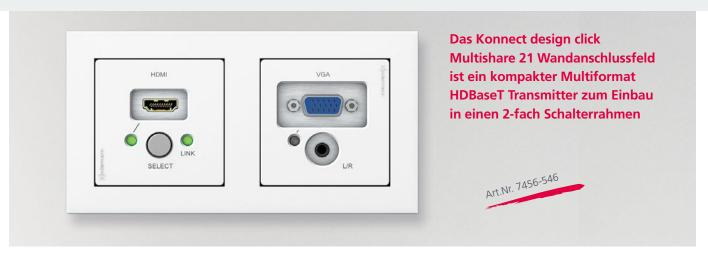
Damit können HDMI, VGA und Audio Signale sowie Steuerungsinformationen über ein einziges CAT-6/7 Kabel bis zu 70 m verlustfrei an einen kompatiblen HDBaseT-Receiver oder Projektor mit HDBaseT übertragen werden. Eine angeschlossene aktive Signalquelle wird automatisch erkannt und ausgewählt oder per Tastendruck umgeschaltet.
